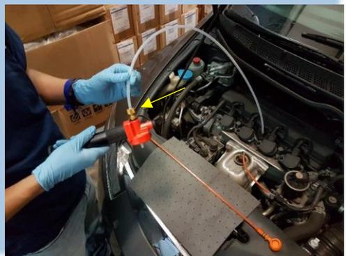
3- Coloque el envase como se muestra y ajuste hasta que quede firme; luego tire del émbolo para lograr la succión
