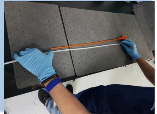
**2- Introduzca la manguera por el orificio hasta la marca del paso anterior e inserte el otro extremo en la bomba y ajuste la rosca hasta que esta quede firme**
